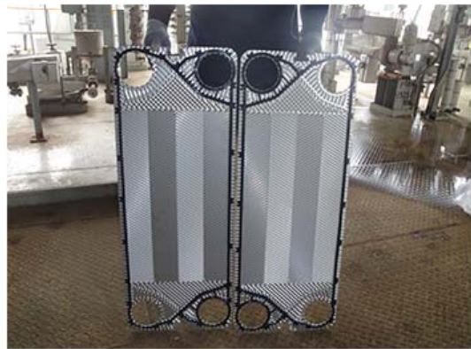
① 플레이트 표면에 누적된 이물질이 있기 때문에 전열성능이 저하됩니다. 깨끗하게 세정 후 제거해야 합니다.
