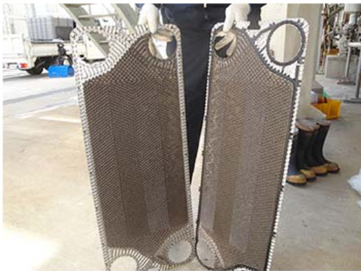
① 플레이트 표면에 누적된 이물질이 있기 때문에 전열성능이 저하됩니다. 깨끗하게 세정 후 제거해야 합니다.
