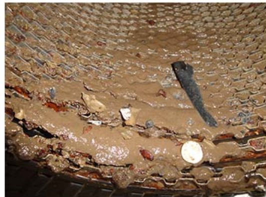
② 유로 입구가 이물질 침전으로 인하여 막힐 수 있으니 장치를 깨끗히 세정하고 제거할 필요가 있습니다.
